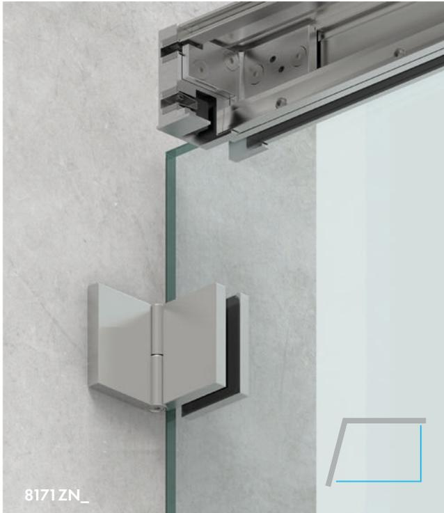
Usinage pour verre 6/8/10 mm : Perçage  $\varnothing$  20 mm ou encoche R35
