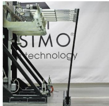
Déformation à 3 kN/m de poussée
