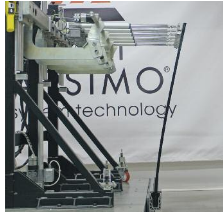
Déformation à 3 kN/m de poussée
