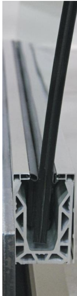
Déformation à 3,6 kN/m de poussée
