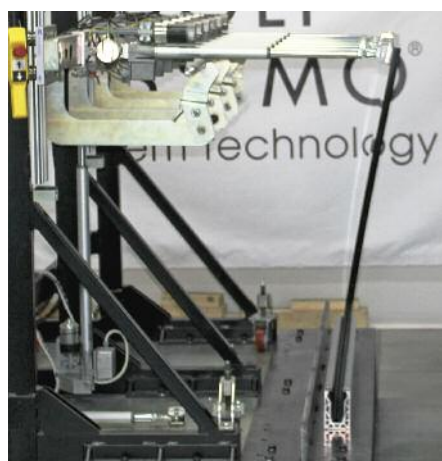
Déformation à 4,5 kN/m de poussée
