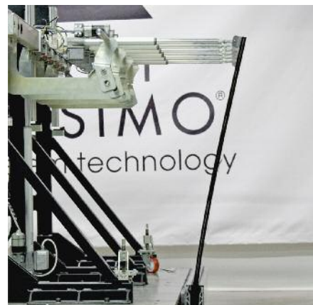
Déformation à 4,8 kN/m de poussée
